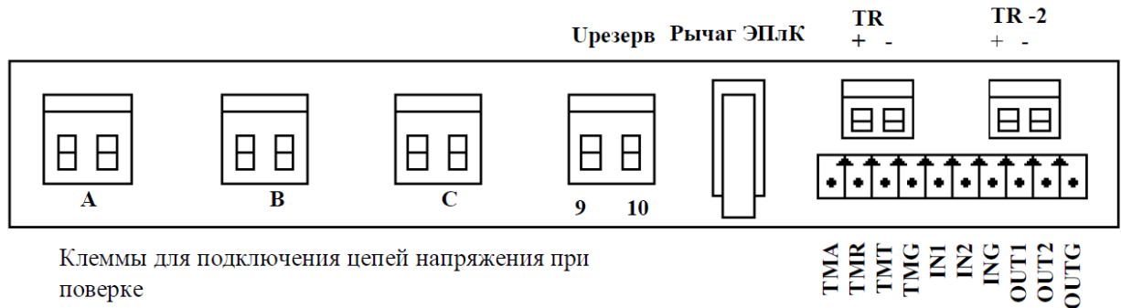
Рисунок В.7 Схема расположения контактов клеммной колодки для подключения счетчиков РИМ 489.14-К, РИМ 489.16-К
